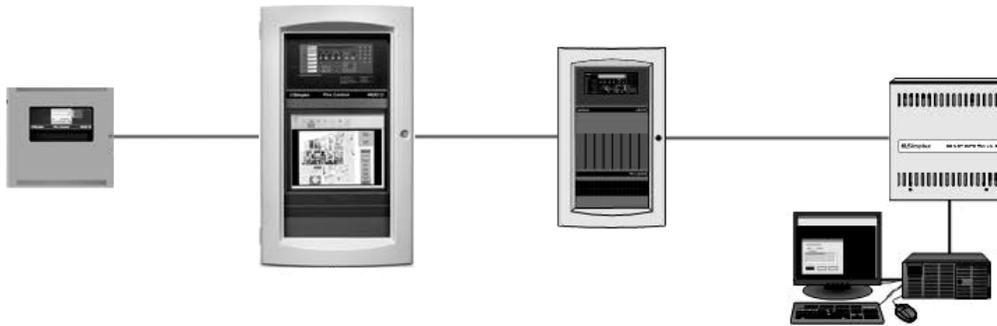
Figura 6: Topología de red lineal con tendido único (sin derivación en T)
